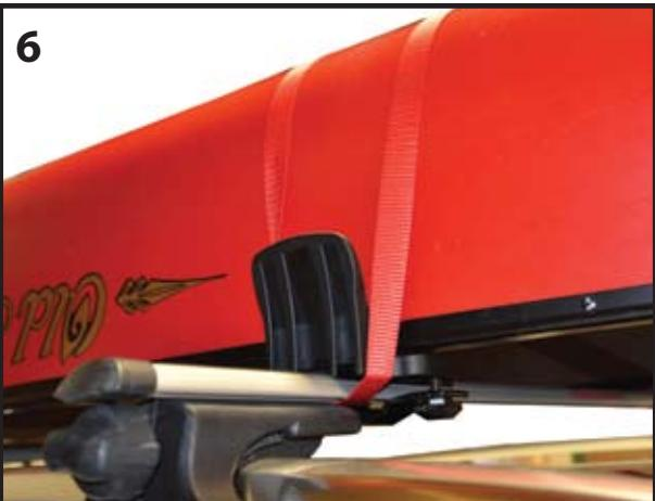
· Faire passer l'extrémité libre d'une sangle sous la traverse. Tirer sur l'extrémité de la sangle jusqu'à obtenir deux parties d'égales longueurs. Mettre les deux parties de la sangle sur le canot. Voir image 6.
