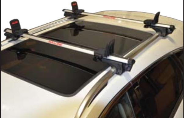
· Installer les trois autres supports à plat-bord en suivant les étapes 1 à 3. Note : ne pas serrer les boutons en T. Les supports doivent être desserrés pour pouvoir les centrer à l'étape 5. Voir image 4.
