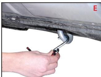
Fixer le crochet en S à l'anneau de remorquage ou à une autre partie solide du véhicule.
