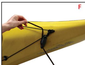
En maintenant la corde serrée et le crochet en place, faire passer l'extrémité libre dans un point d'attache sur le kayak.
