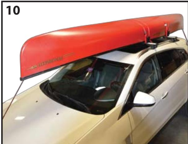
Après avoir bien installé les deux sangles et les deux cordes de sécurité, le canot devrait être arrimé solidement au véhicule. Voir image 10.
